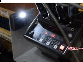
Godox A1 でのテスト撮影状況 スタジオ用の大型ストロボを二灯使用しているが、出力値は (6W+13W) と最小値に近く絞っている iPhone・iPad 撮影ならむしろ小型クリップオンストロボの出力で充分だろう なお A1 は背面マグネットを利用して、ストロボジェネレータ横に置いたスチール製のブックエンドに張り付けている この状態でジェネレータ右側の白い円形の光スレーブ受光部に感知させている
