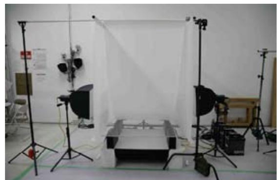
商品を置くアクリルの板の左右にボックスライトがあり、奥側と両サイドがディフューザー（主にライトの光を拡散させ、やわらかい光にするための白
