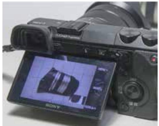
背面のモニターは上下に角度調整、マス目表示も出来る
